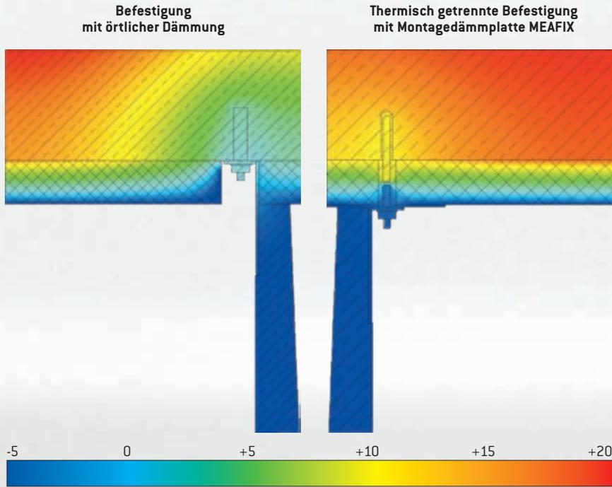
Direkter Vergleich des Temperaturverlaufs. Temperaturangaben in °C.
