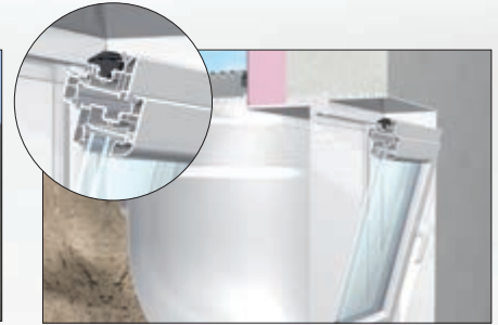
Schneller ist ein Fenster nicht einzubauen: Ein speziell entwickelter Clip am Dreh-Kipp Einsatz ermöglicht ein einfaches Einsetzen und Einklicken in die Zarge – ohne Werkzeug oder Montage von Beschlagsteilen. Einsetzen – Einklicken – Fertig.
