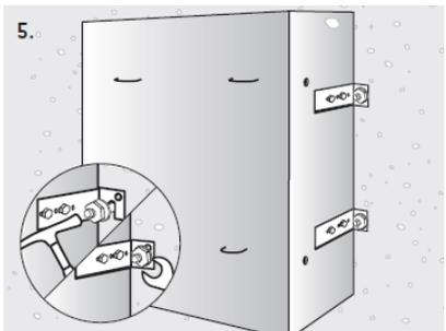
**1.)** Befestigen Sie die Haltewinkel mit zwei Schrauben je Haltewinkel an der Außenwand des Lichtschachts.
