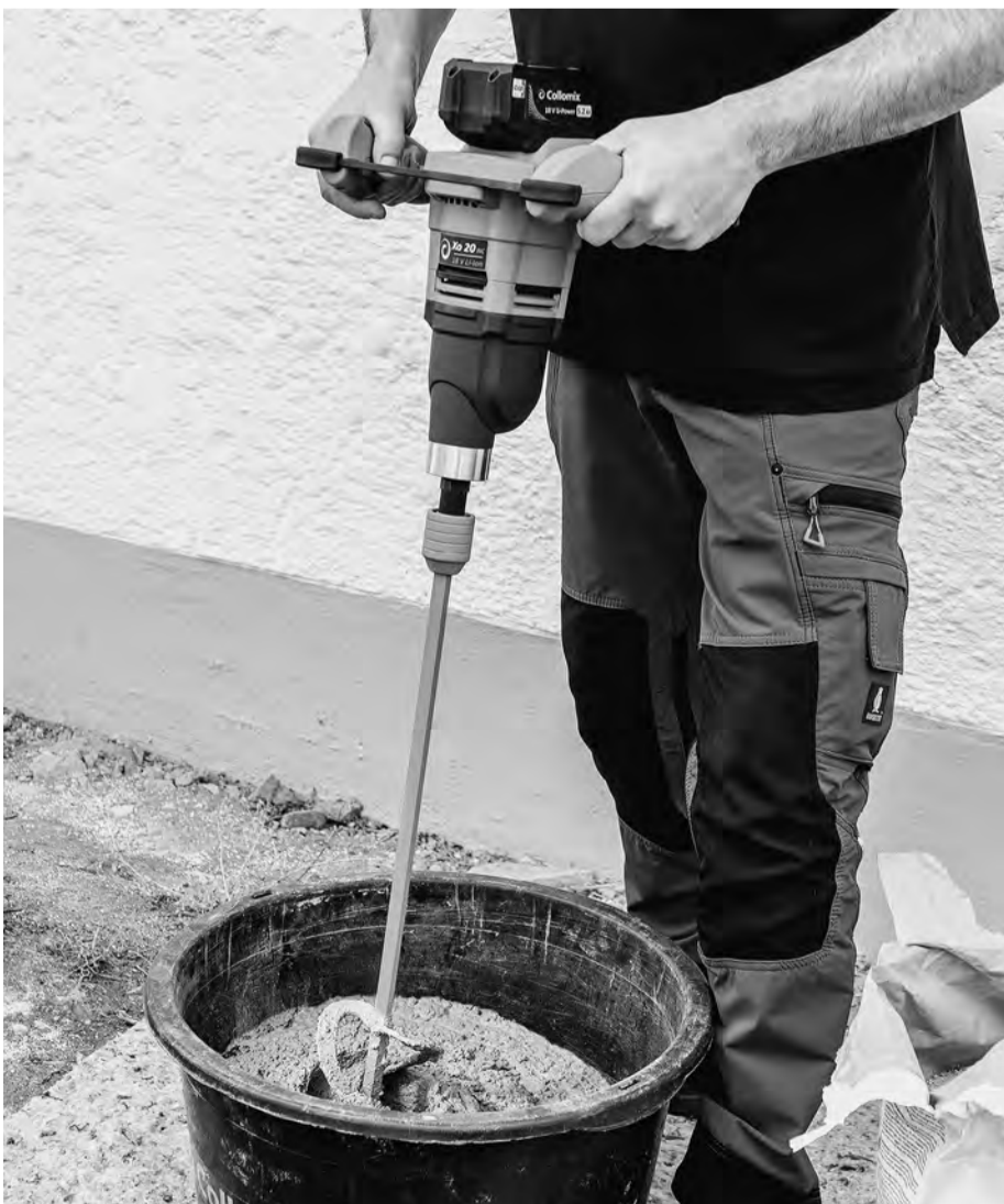
Mörtel oder Estrich mischen Anwender mit langsamer Drehzahl und hoher Kraft im ersten Gang, mit dem schnelleren Gang homogenisieren sie pulverförmige Materialien wie Kleber, Spachtel oder Nivelliermassen. FOTO: COLLOMIX
