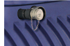
Detail vypouštěcího ventilu
