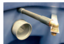
Detail postřikovací trysky na škrob
