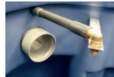
Detail postřikovací trysky na škrob
