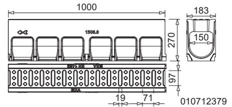
**MEADRAIN DM CITY 1500 Corps de caniveau, classe de charge D 400 selon norme EN 1433**
