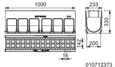
**MEADRAIN DM CITY 2000 Corps de caniveau, classe de charge D 400 selon norme EN 1433**
