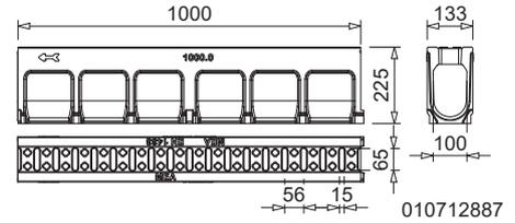
**MEADRAIN DM CITY 1000 Corps de caniveau, classe de charge D 400 selon norme EN 1433**
